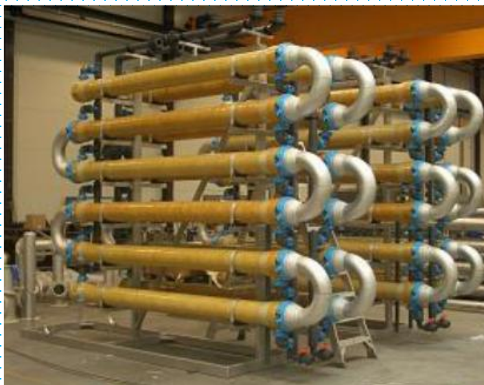
Модуль ультрафильтрационных мембран выносного типа Cross-Flow
